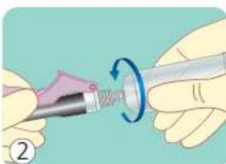
Visser à fond le corps sur l'aiguille (faire tourner le corps, sans bouger l'autre main qui maintient l'aiguille).
